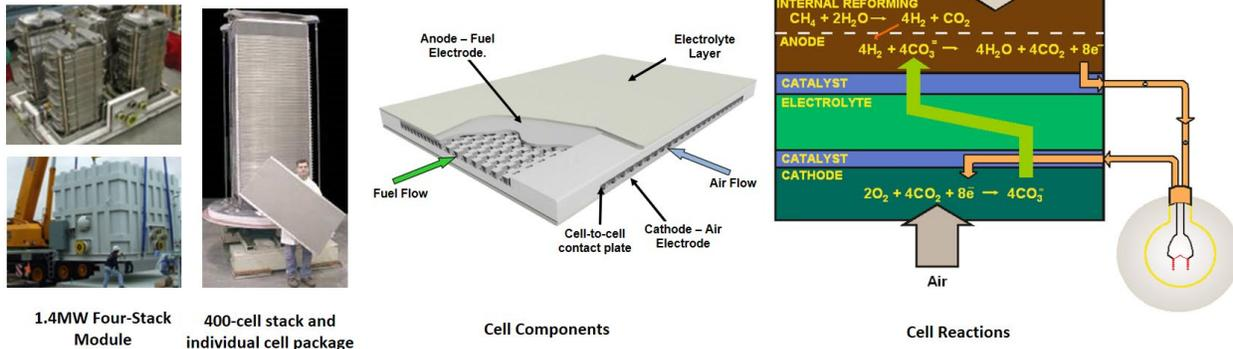
1.4MW Four-Stack Module
